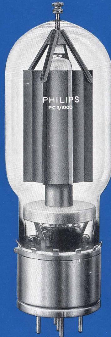
Falls während des Betriebes die Anodenspannung unter den Wert der Schirmgitterspannung sinkt, so wird das gute Arbeiten der Röhre nicht durch die Emission von Sekundärelektronen durch die Anode beeinträchtigt. Auch die Emission von Sekundärelektronen durch das Schirmgitter hat hierauf keinen Einfluss. Die Röhre hat darum eine beträchtliche Ausgangsleistung bei einem hohen Wirkungsgrad.
